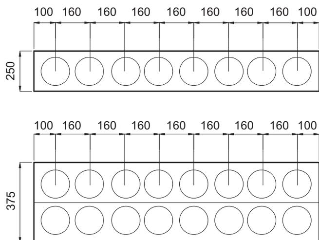
Lorsque des buses de sortie de 150 mm et plus sont utilisées par paire, la dimension d'origine ainsi que la dimension de l'axe changent.
